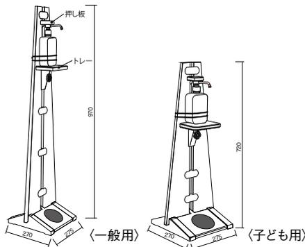
完成品で組立不要。ペダル部分を軽く踏むだけで押し板がポンプ部分を押し下げるので、簡単にお使いいただけます。容器の取り付けも、サイズに合わせて高さを調節、固定するだけで、簡単に行えます。
